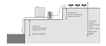
Em cabeçotes rasos (1m), com comprimento de mangueira curto, o SE1 pode fornecer até 0.44 l/s de água, o que equivale a 1.600 l/hr ou mais de 9.500 litros por dia de bombeamento de 6 horas.
