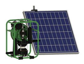
A Futurepump solar tem três partes principais: A fonte de energia (Paineis PV - 60W), que converte a luz solar em energia elétrica para direção, o motor CD que gira um volante que aciona uma bomba de pistão alternativa, de deslocamento positivo e de alta eficiência.
