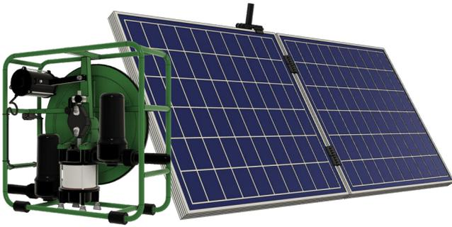
A Futurepump solar tem três partes principais: A fonte de energia (Painéis PV), que converte a luz solar em energia elétrica para direção, o motor CD que gira um volante que aciona uma bomba de pistão alternativa, de deslocamento positivo e de alta eficiência.
