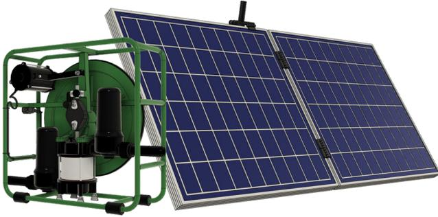
Les pompes solaires Futurepump ont trois parties principales: la source d'alimentation (panneaux photovoltaïques) qui convertit la lumière du soleil en énergie électrique pour entraîner, le moteur à courant continu qui fait tourner un volant d'inertie, qui entraîne une pompe alternative à piston, à déplacement positif et à haut rendement.
